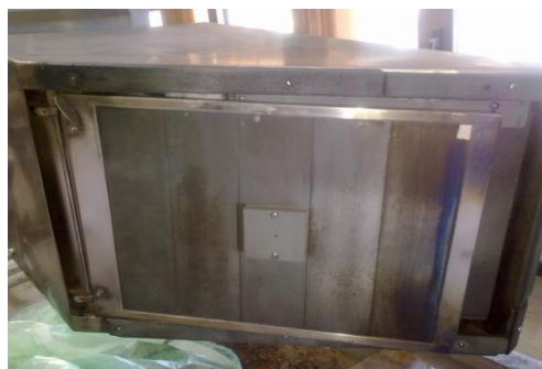
شکل (۵): حفره ورود پرتو به فنجان فارادی نصب شده روی درب کلکتور
